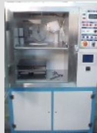
Equipamento de vazamento de resinas de poliuretano em vácuo, desenvolvido e comercializado por um consórcio composto pelo INEGI e pela empresa M. J. Amaral.
